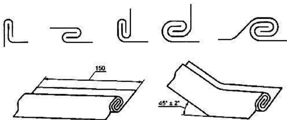
Рисунок В.1 - Схема соединения в двойной кровельный замок
