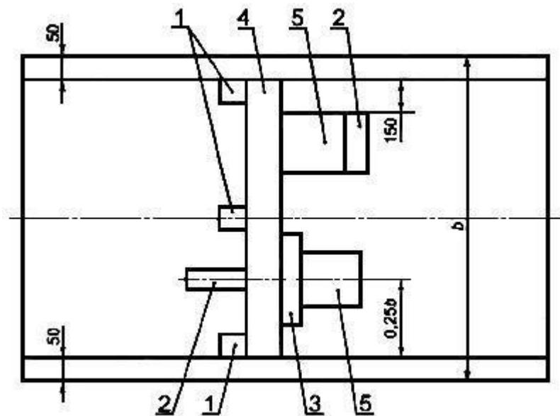
$b$  - ширина проката, мм; 1, 2, 4, 5 - образцы; 3 - заготовка
