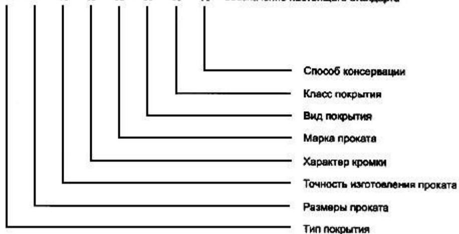
Прокат с цинковым покрытием ГЦ в листах толщиной 1,0 мм, шириной 1000 мм, длиной 2000 мм, категории точности изготовления Б, с необрезной кромкой НО, марки 01, с покрытием с нормальным узором кристаллизации цинка Н, класса 275, промасленный ПР:
